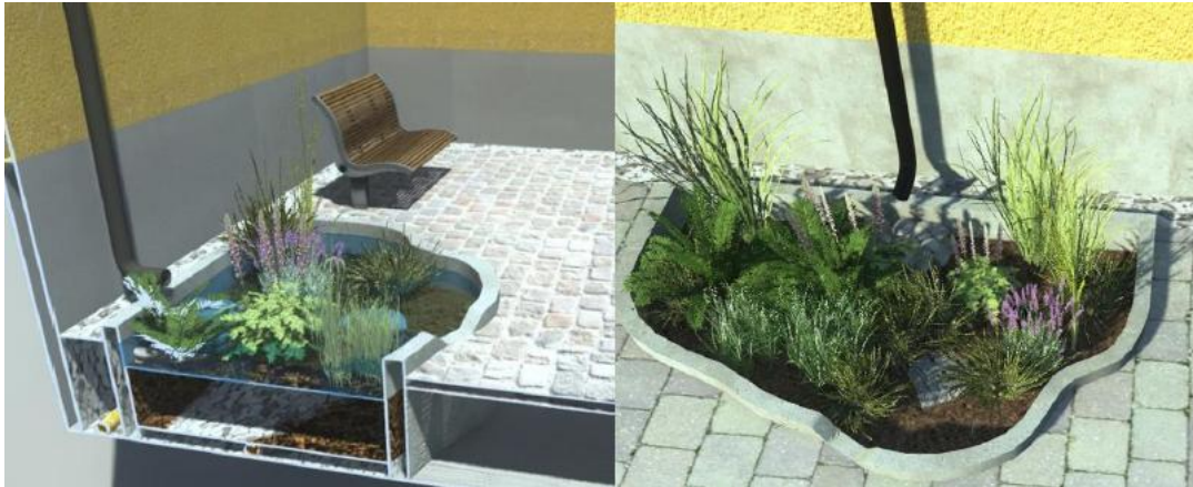
Figur 17. Exempel/inspirationsbild på växtbäddar som är nedsänkta i förhållande till marknivå. Källa: Nacka kommun.
